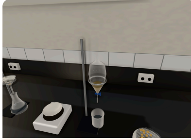
Ayırma hunisi: alttaki su akıtılır, yağ hunide kalır.
