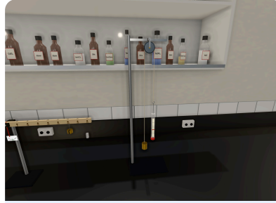
Sabit makara: kuvvetin yönü değişir. Büyüklüğü ideal durumda değişmez, sürtünme nedeniyle biraz artar.
