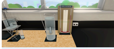
Sonda suda 20 cm derinde, aşağı bakıyor. Manometre seviye farkı 20,0 cm, gösterge basıncı 1962 Pa.
