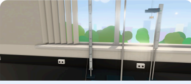
L = 1,00 \text{ m} , 12^\circ açığı. Bırakıldıktan sonra sayaç periyodu 2,011 s gösterir, küçük açı değeri 2,006 s'dir.
