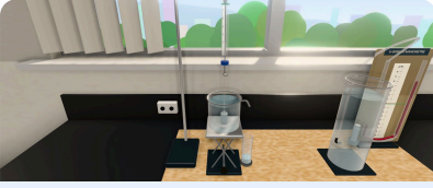
Alüminyum silindir suya tamamen batık. Dinamometre 0,35 N, F_k = 0,196 N ve taşan hacim 20,0 mL okunur.
