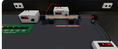
Lazer modelinde uyarılmış atomlar ve rezonatör aynaları, eşik üstünde yönlü ışın oluşturur.
