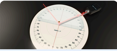
Akrilikten havaya 50^\circ ile çıkan ışın. Sınır açısı ( 42,2^\circ ) aşıldığı için kırılan ışın yoktur, yansıyan güç %100'dür.
