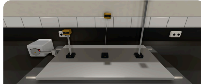
Sarsma masasında farklı boydaki üç bina, sürme frekansı doğal frekansına yaklaştığında farklı genlik verir.
