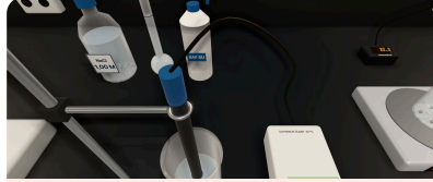
İletkenlik hücresi 100 mL ölçü balonundan hazırlanmış \text{NaCl} çözeltisinde.
