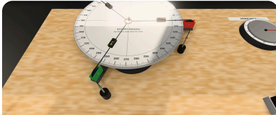
Üç ip kuvvet masasında halkayı merkezde tutar. Sensörler gerçek gerilmeleri gösterir.
