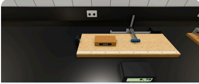
Yatay tahtada motorlu çekici bloğu çeker. Kuvvet algılayıcısının okuması veri kaydedicide görünür.
