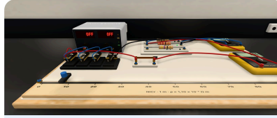
Dört AA pil seri bağlı, yük 22 \Omega . Eş emk 6,00 V, iç direnç 1,00 \Omega olduğundan uç gerilimi 5,74 V'a düşer.
