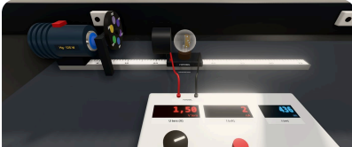
Fotoelektrik düzeneğinde filtre tekerleği seçili dalga boyunu fotoselin katoduna gönderir. Ters gerilim fotoakımı azaltır.
