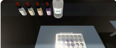
Mikro kuyucuk şeridinde CO 2 deneyi ölçüm anında. Ayıraç ve yaprak bölmeleri kapalıdır.
