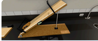
Krikolu eğik düzlemde pim kaldırılınca blok ışık kapısına kayar ve süre ölçülür.
