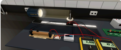
Lamba, ışınım ölçer ve döner güneş pili optik rayda. Reosta yükü I-V eğrisini tarar.
