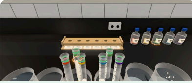
pH serisi, 37 °C, 60. saniye: köpük pH 7 tüpünde 116 mm, pH 3 ve pH 11 tüplerinde yalnızca 4 - 6 mm kadardır.
