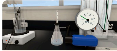
Vakum düzeneğinde 9 strok sonra basınç yaklaşık 30 kPa'a iner. Başlangıçta 70 °C olan su 69 °C'ta kaynamaya başlar.
