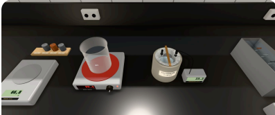
Isıtılmış metal silindir kalorimetre suyuna aktarılır. İki prob ısı dengeye yaklaşmayı gösterir.
